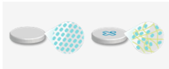
En kristallin form av en läkemedelssubstans definieras genom en specifik ordnad struktur medan en amorf form definieras som avsaknaden av en sådan ordning.
